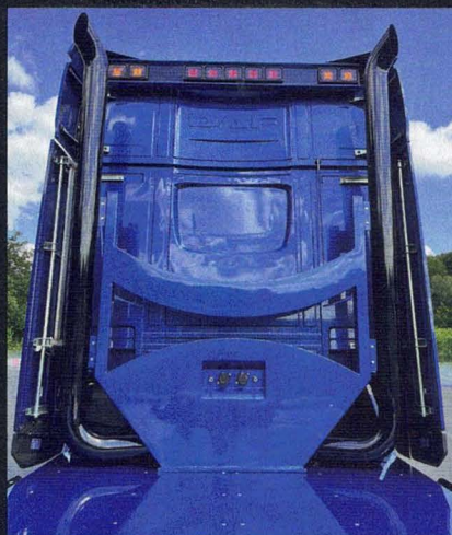
Die Auspuffrohre aus 160er-Edelstahl dienen als Frischwasserbunker
